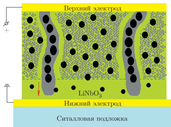
Рис. 9. (В цвете онлайн) Структура М/НК/М в HRS после циклических РП и приложения положительного потенциала на верхний электрод. Серые области, окружающие цепочки гранул, представляют металлический конденсат, который возникает в результате процесса нуклеации атомов Со и Fe и кислородных вакансий при протекании тока через перколяционные цепочки, образованные гранулами
