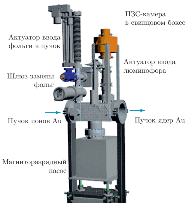
Рис. 1. Трехмерная модель узла станции обдирки
