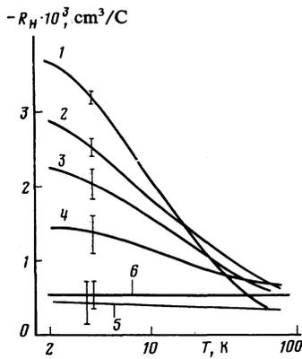
FIG. 4. Hall coefficient  $R_H$  of  $Ce_x La_{1-x} Cu_2 Si_2$  for different values of  $x$  (1—1; 2—0.9; 3—0.5; 4—0.3; 5—0.2; 6—0).
